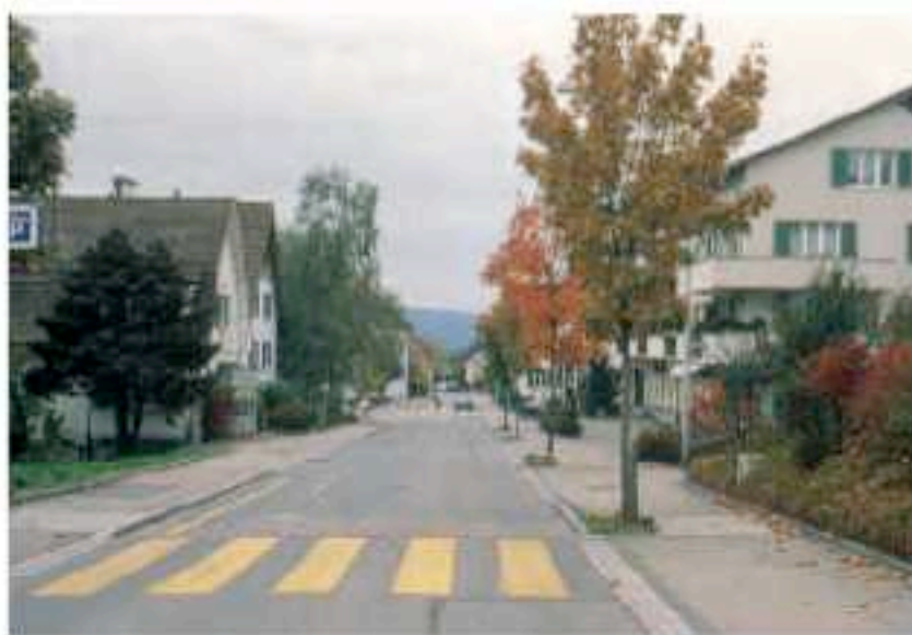
Baumreihe in Gehweg integriert, geschützte Fussgängerübergänge
